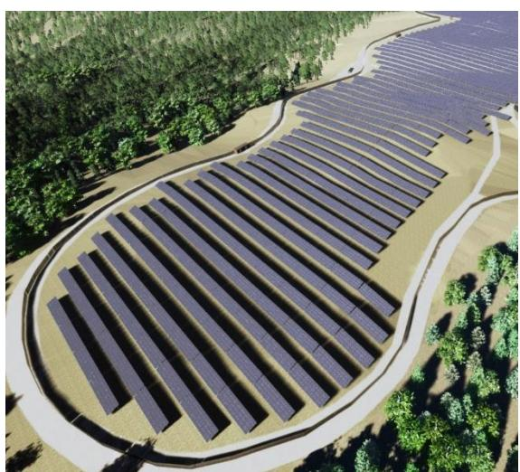
Situé sur la commune de Châteauvert dans le Var, au cœur du lieu-dit Margui, le projet s'étend sur une superficie de 13,5 ha pour une puissance totale de près de 11 MWc (puissance atteinte par les panneaux solaires lorsqu'ils sont exposés à un rayonnement solaire maximal). La centrale sera composée de 790 tables fixes de 32 panneaux photovoltaïques.
